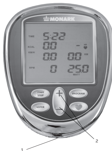
Fig: Belastningsreglering och anslutningar
