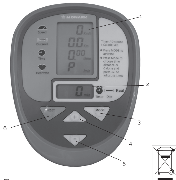
Fig: Electronic display. 1) Upper display 2) Lower display 3) MODE button 4) (+) button 5) (-) button 6) RESET button
