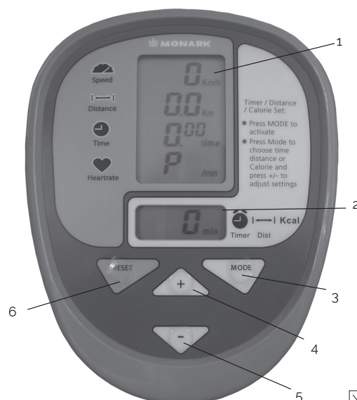
Fig: Elektronisk display 1) Övre display 2) Nedre display 3) MODE-knapp 4) (+)-knapp 5) (-)-knapp 6) RESET-knapp
